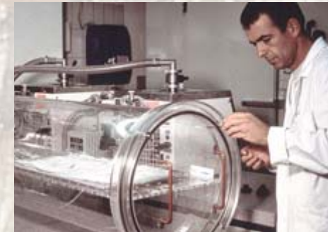
Gefriertrocknung eines archäologischen Gewebes.
